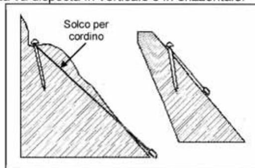
Figura 48. Ancoraggio con piccozza in verticale
