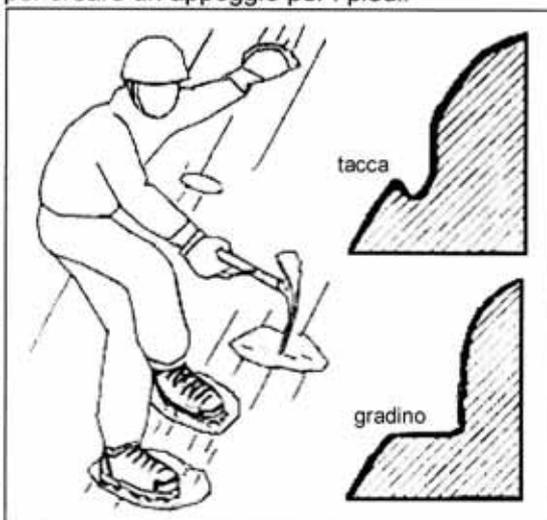
Figura 46. Taglio di gradini con piccozza.
